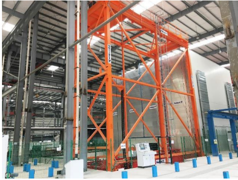
Figura 23. Equipo de volteo de bandejas Vario Turn altamente moderno y guiado por eltecho para la producción de muros dobles 34
