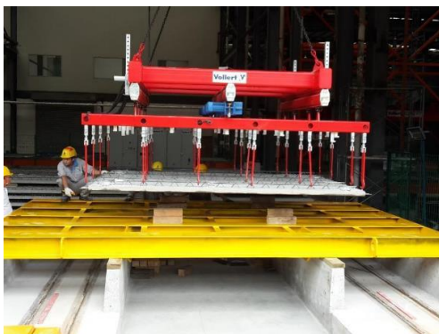
Figura 26. Un carro elevador de vaivén Smart Logistic comunica la zona de carga con el lugar de almacenamiento en la zona exterior 90
