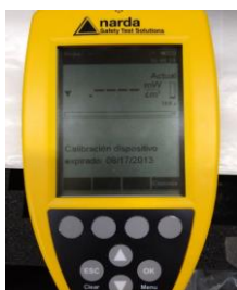
Figura 8. Calibración del instrumento Narda NBM550
